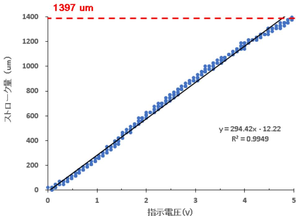
図2 Z1000 の最大ストローク(変位置)と制御電圧の関係
